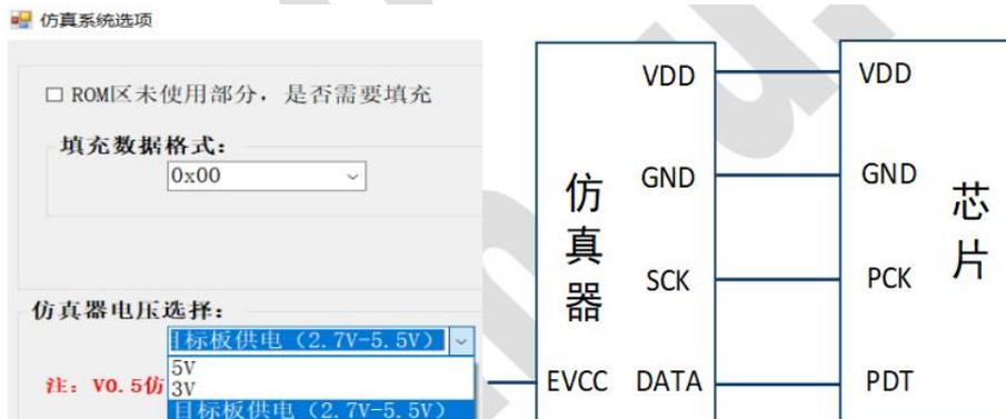
注: 跳线连接接线如上图所示, 外部电源输入接仿真器的 EVCC 脚。
