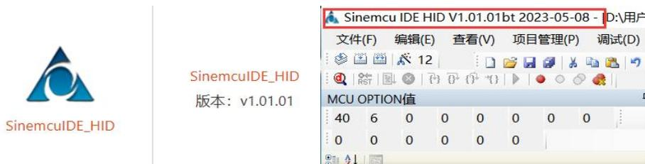
使用 HID 版本仿真软件下载程序后，上位机与仿真器通信方式会自动转换成 HID，此时仿真软件下方状态栏显示如下图所示：
