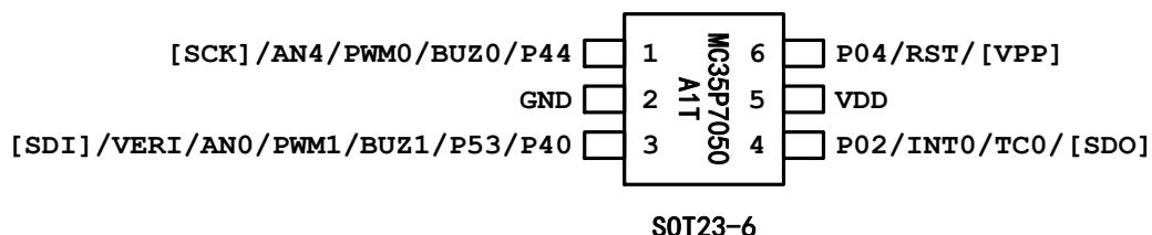
注: PIN3 是端口 P40 和 P53 同封在 1 个引脚上, 使用时应确保 2 个端口的工作模式、上拉电阻、复用功能、数模端口等设置不会产生冲突; 若应用 P40 的 AD 功能时, 静态功耗会偏大约 100 $\mu$ A。
