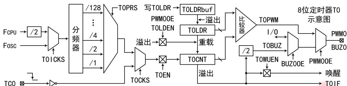
PWM0OE=0 且 BUZ0EN=1 时，定时器 T0 可实现 BUZ 功能，端口将输出频率为 T0 溢出频率 2 分频的蜂鸣器驱动信号。
