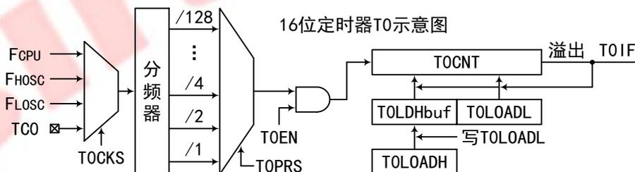
定时器 T0，可通过寄存器位 T0CKS 选择时钟源，通过 T0PRS 选择预分频比，所选时钟源通过预分频器后产生 T0 计数器 TOCNT 的计数时钟（上升沿计数）。预分频比可选择 1~128 分频，对 TOCNT 的写操作将清零预分频计数器，而预分频比保持不变。16 位 TOCNT 的高字节 TOCNTH 配有缓冲器，对 TOCNTH 的读写操作实际为对缓冲器执行读写操作，TOCNTH 的实际内容仅在读写 TOCNTL 时才自动与缓冲器中内容同步，因此写 TOCNT 需先写 TOCNTH 再写 TOCNTL，而读 TOCNT 则需先读 TOCNTL 再读 TOCNTH。
