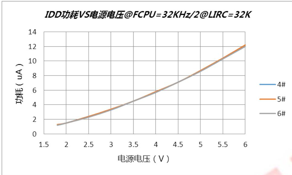
**HOLD 模式 功耗 VS 电源电压**
