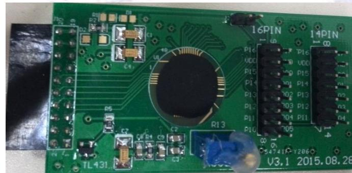
**注意：EV板有两种版本V2.1和V3.1，V3.1可以直接使用，V2.1属于老版板子+新芯片，也可以用，在使用时要填写VREF校准值，板子上有黑笔写的一组数字，编译时填写在编译器相应位置，即可仿真。**
