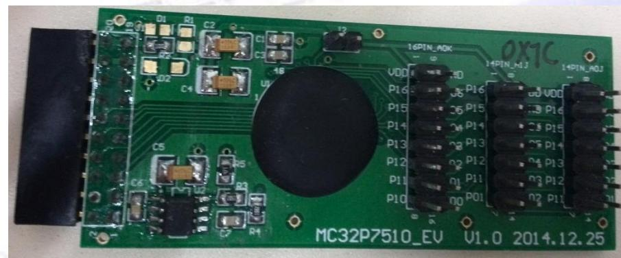
注意：EV板有两种版本V1.0和V1.1，V1.1可以直接使用，V1.0仿真时需要填写内部高频校准值，写在板子上的一组黑色数字，编译时填写在编译器相应的位置（IDE使用说明书里有）。
