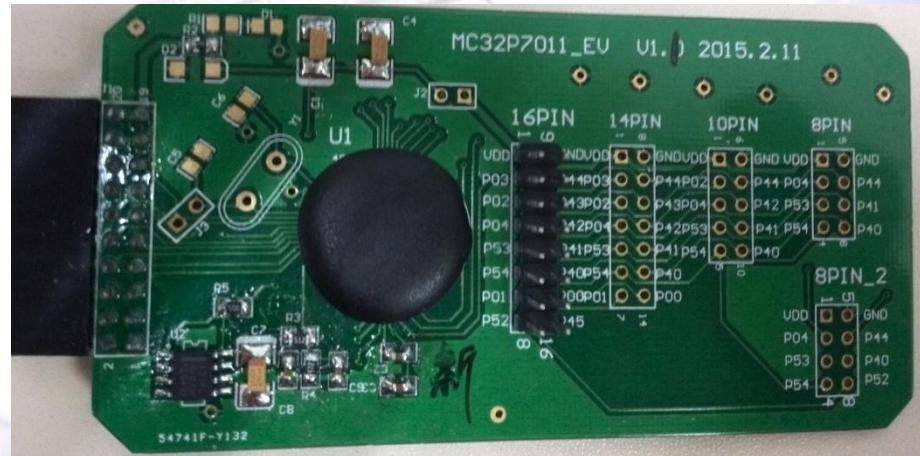
注意：EV板有两种版本V1.1和V2.1，V2.1可以直接使用，V1.1属于老版板子，也可以用，在使用时要填写VREF校准值，板子上有黑笔写的一组数字，编译时填写在编译器相应位置，即可仿真。
