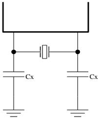
使用外部晶体作为内部模块的低频时钟源时，连接方式见左图。低频一般是接 32768Hz 晶体，通常  $C_x$  是必须的。
