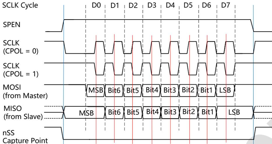
当 CPHA=1, 主设备在 SCLK 的第一个沿将数据输出到 MOSI 上, 从设备把 SCLK 的第一沿作为开始发送信号, SCLK 的第二个沿开始捕获数据, 因此用户必须在第一个 SCLK 的两个沿内完成写 SPDAT 的操作。这种数据传输格式是一个主设备一个从设备之间通讯的首选。
