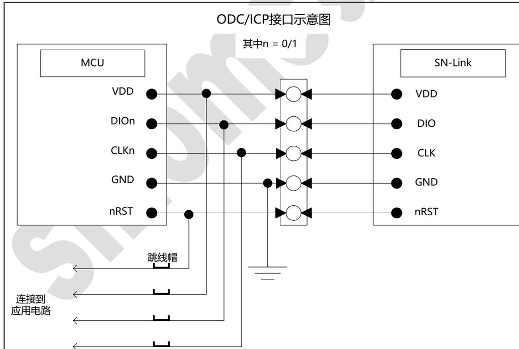
片上调试 OCD 和在电路编程 ICP 接口整理
