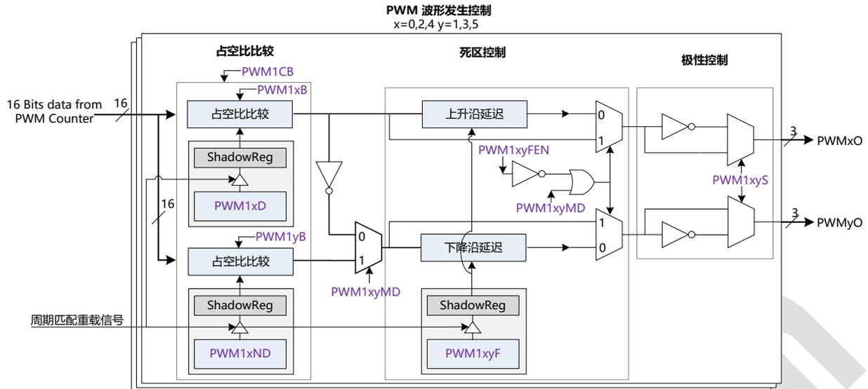
PWM1 具有 3 个独立的波形发生模块，通过寄存器配置可设置为 3 路互补 PWM 输出或 6 路独立 PWM 输出。在作为互补输出时，可以控制死区时间。
